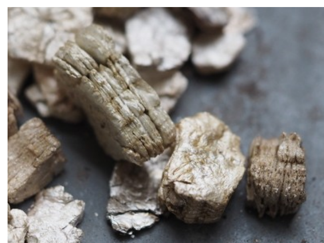
2:1型粘土 バーミキュライト 園芸用の倍土でよく 使われる
